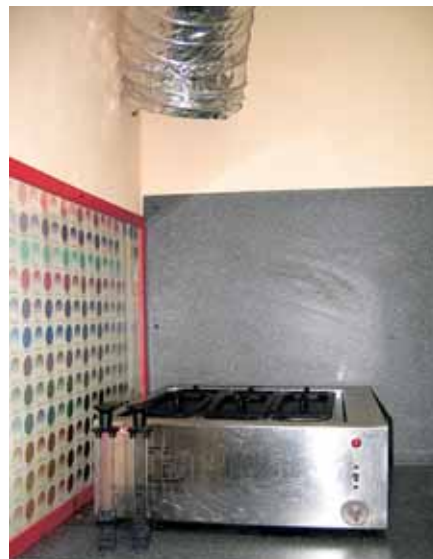
Установка для окрашивания линз с местной вытяжкой
