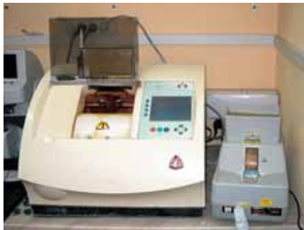
Станок Practica компании Indo International (слева) и ручной доводочный станок китайского производства (справа)
