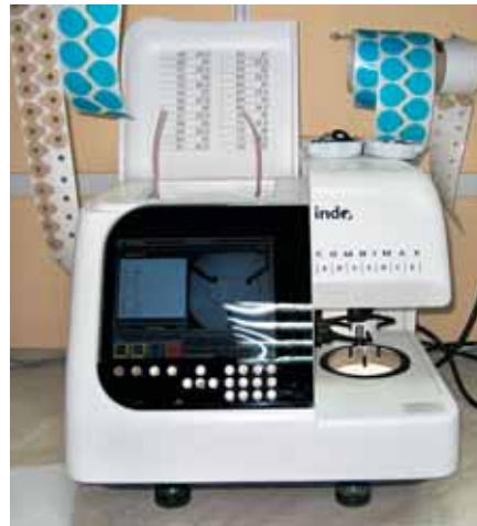
Сканер оправ Combimax Advance производства Indo International, совмещающий функции автоматического сканирования, центрирования и блокировки линз
