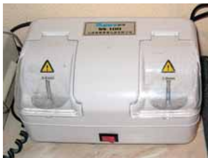
Станок Supore для вырезания боковых пропилов при сборке очков с креплением линз на винтах
