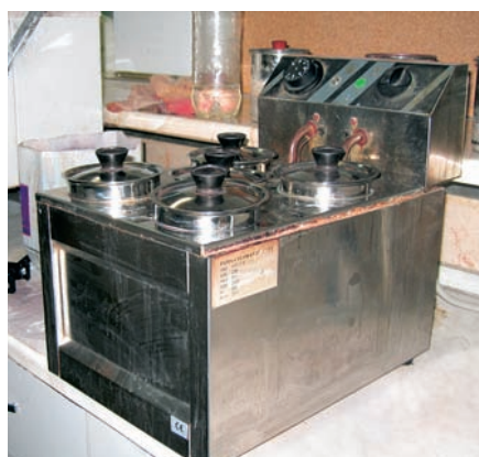
Красильная установка Pama Coloranti
