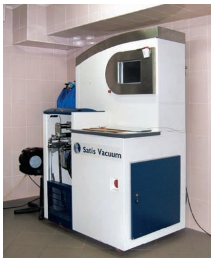
Вакуумная установка SP-200 (Satis Vacuum) для нанесения просветляющих покрытий
