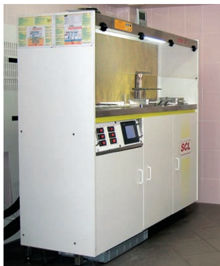
Установка фирмы SCL для нанесения упрочняющих покрытий
