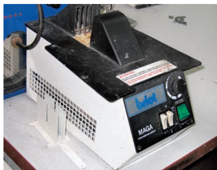
Фен Мага (GFC) для разогрева и выправки пластмассовых оправ
