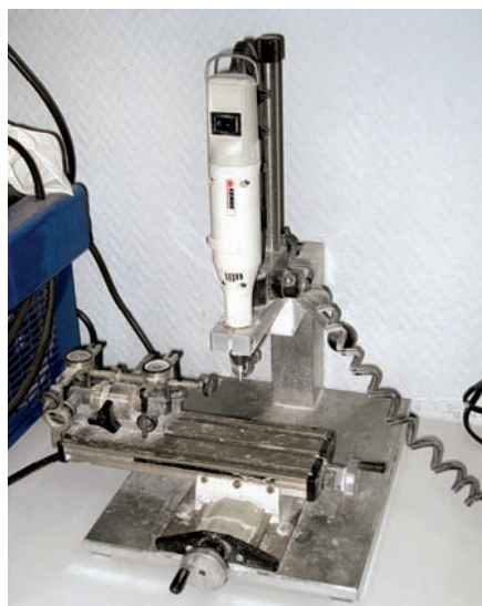
Сверлильный станок Xenox (Breitfeld & Schliekert)
